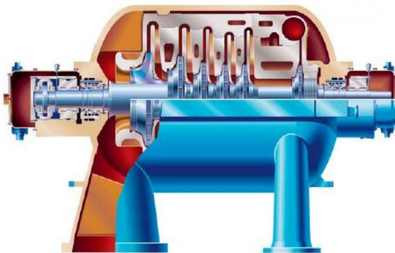
**Figura 9.** Compresor centrífugo multietapa de succión simple.
